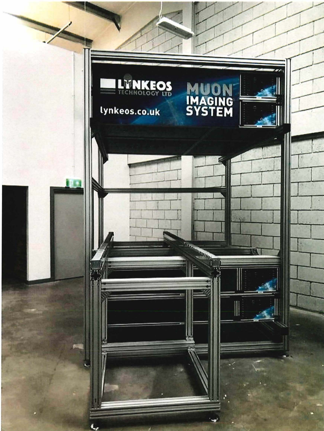
Abb. 3: Das Lynkeos MIS vor der Auslieferung an das NNL Central Laboratory im Jahr 2018. Abgebildet sind die beiden Detektorpaare mit einem 1-Tonnen-Traglast-Rollentisch in der Mitte. Auf der Unterseite des oberen Detektorpaares zeigt das unten links gezeigte Quadrat den aktiven Bereich des Systems an. Der Rest des Detektorbereichs stellt die Ausleseelektronik und Stromversorgung dar.
