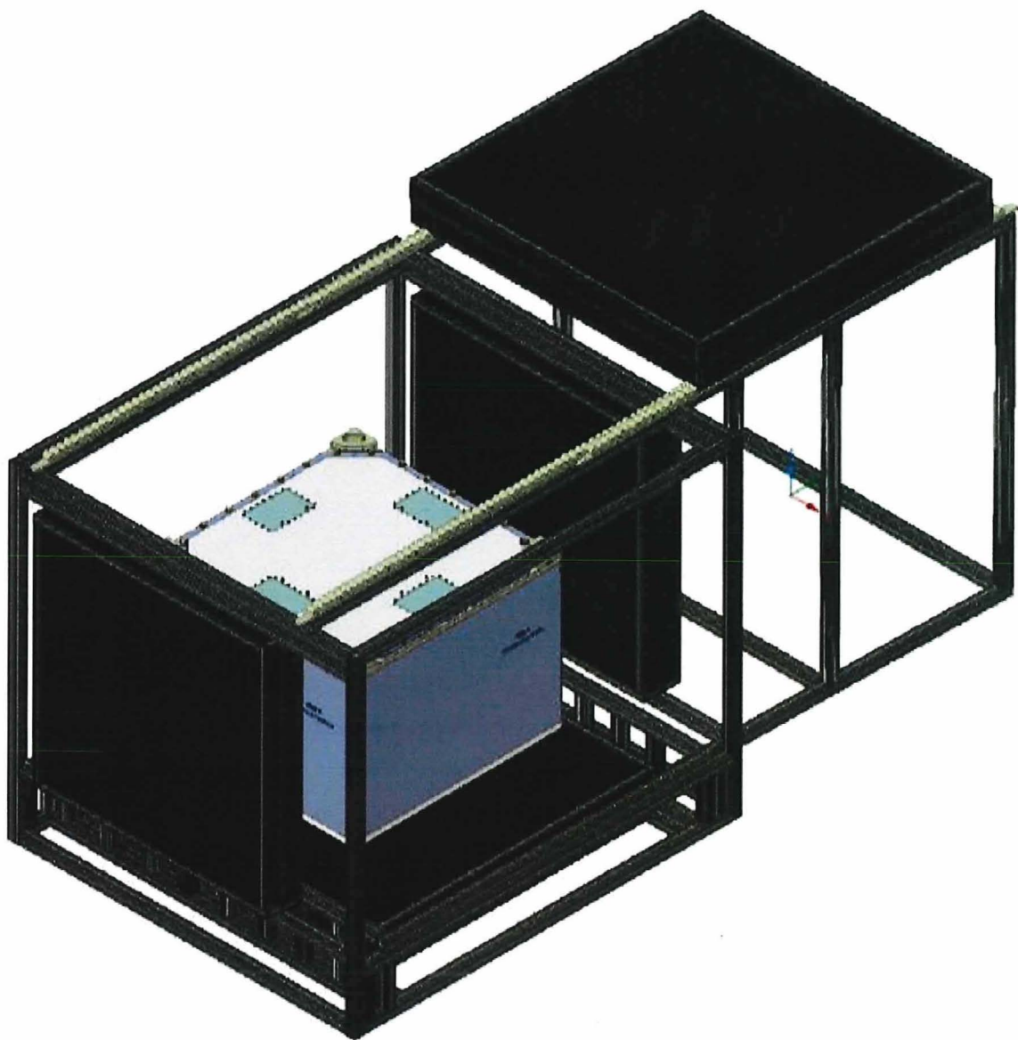
Abb. 24: Konzeption eines vierseitigen MIS für die Zustandsüberwachung und Inspektion von 3m 3 Behältern für die UK Nuclear Industry. Diese Ausrichtung der Detektormodule ermöglicht eine große Flexibilität bei den erforderlichen Messungen, einschließlich der Identifikation der Phasengrenzen.
